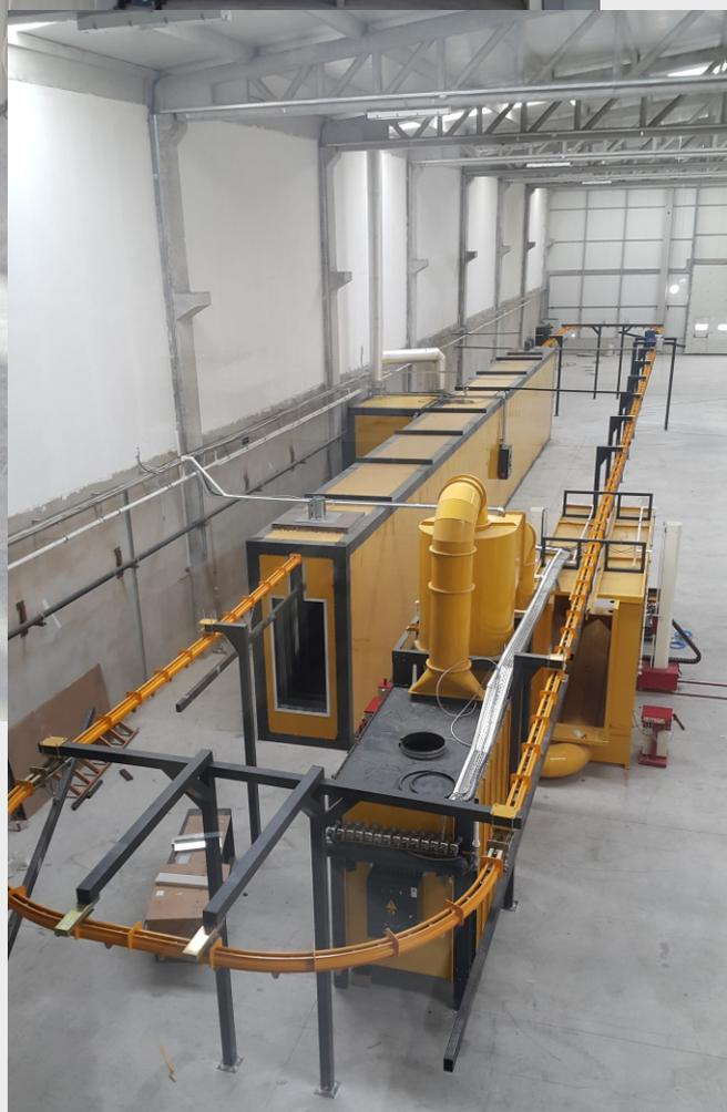
**У ПОВОРОТА ТИП ПЕЧИ ДЛЯ ОТВЕРЖДЕНИ / U TURN TYPE CURING OVENS**
